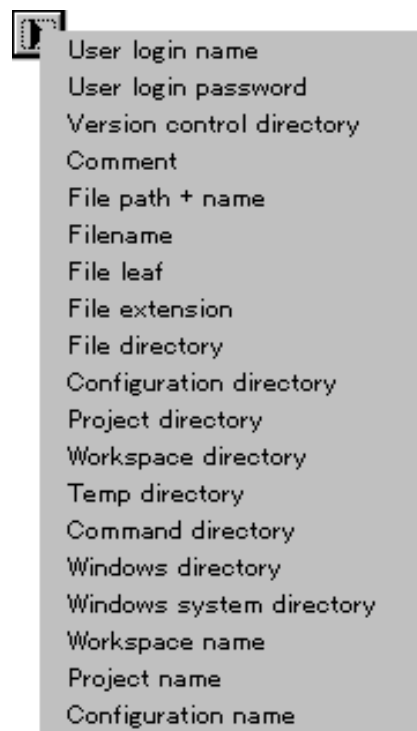
図 8.6: 変数フィールドプレースホルダのポップアップメニュー
