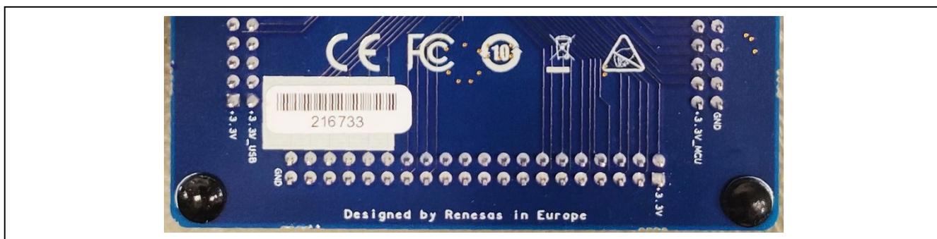
図 6 EK-RA4M2 評価ボードのシリアルナンバーの識別
