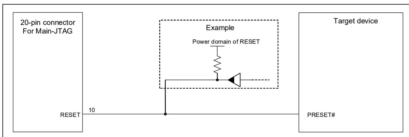
図 2-6 リセット回路接続例
