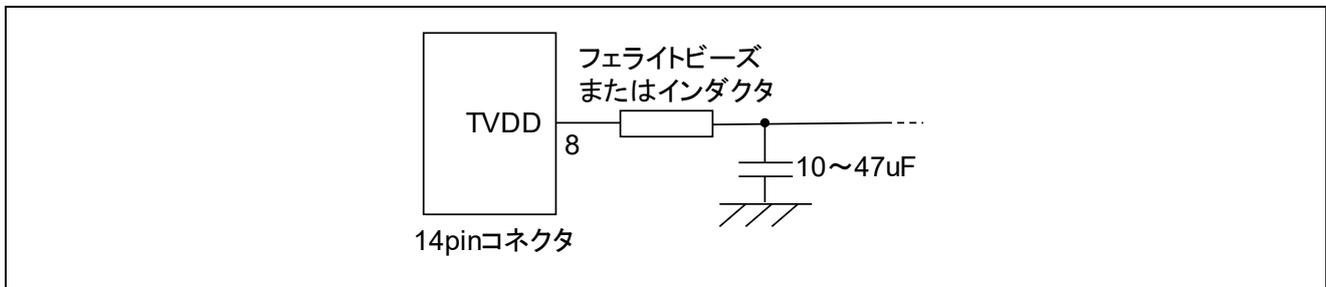
図 2-7 ホットプラグイン向け対策回路
