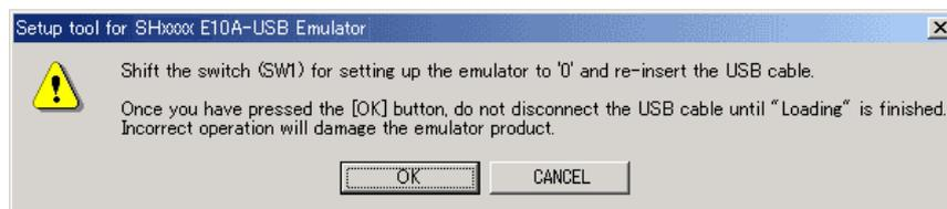
图 3.24 [Setup tool for SHxxxx E10A-USB Emulator] 对话框
