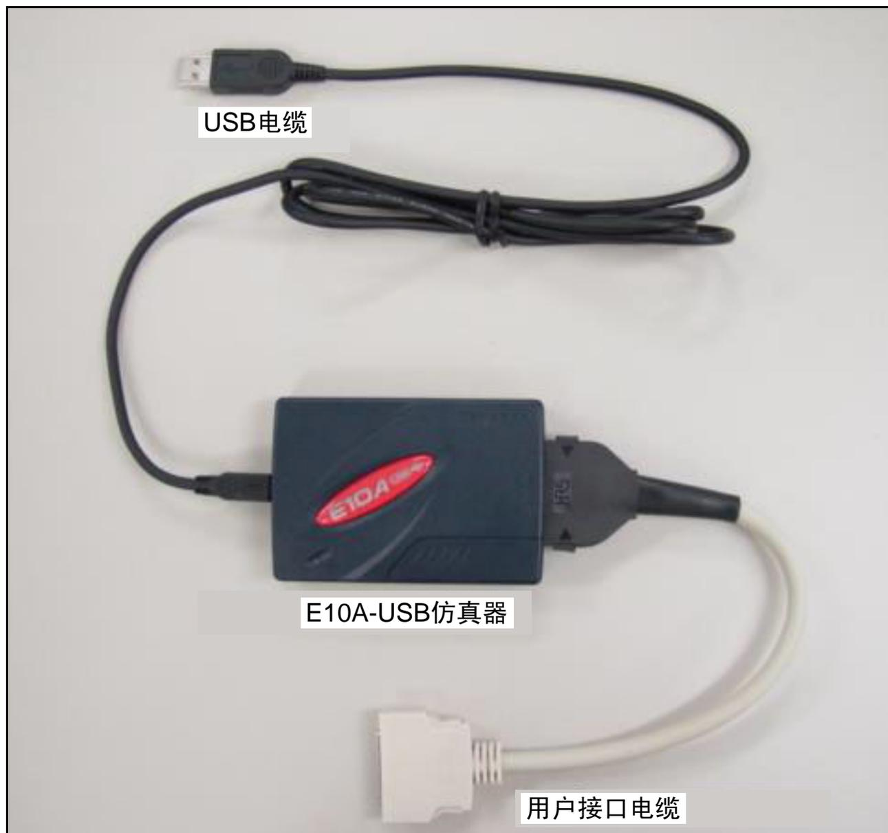
图 3.2 E10A-USB 仿真器的硬件构成（36 引脚的电缆）
