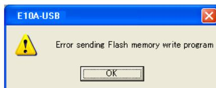
图 3.58 [Error sending Flash memory write program] 对话框
