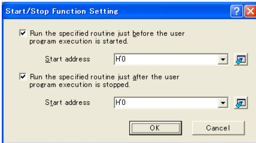
图 5.52 [Start/Stop Function Setting] (启动 / 停止功能设置) 对话框
