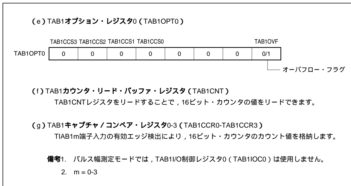
図7 - 36 パルス幅測定モード動作時のレジスタ設定内容 (2/2)
