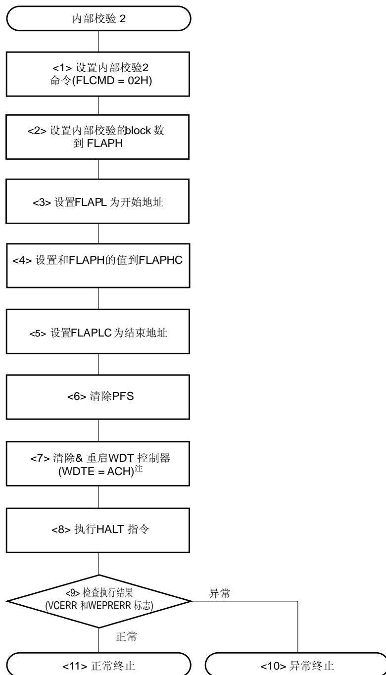
图 15-26. 自编程模式下内部校验 2 操作示例
