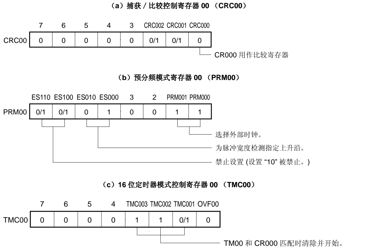
图 6-14. 外部事件计数器模式下的控制寄存器设置 (指定上升沿)
