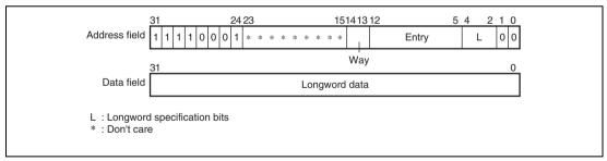
Figure 8.6 Memory-Mapped IC Data Array
