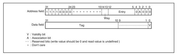
Figure 8.5 Memory-Mapped IC Address Array
