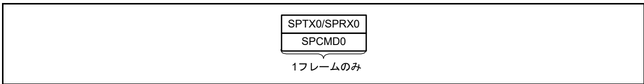
図 32.41 シーケンス動作時の SPI コマンドレジスタと送受信バッファの関係 (SPI1)
