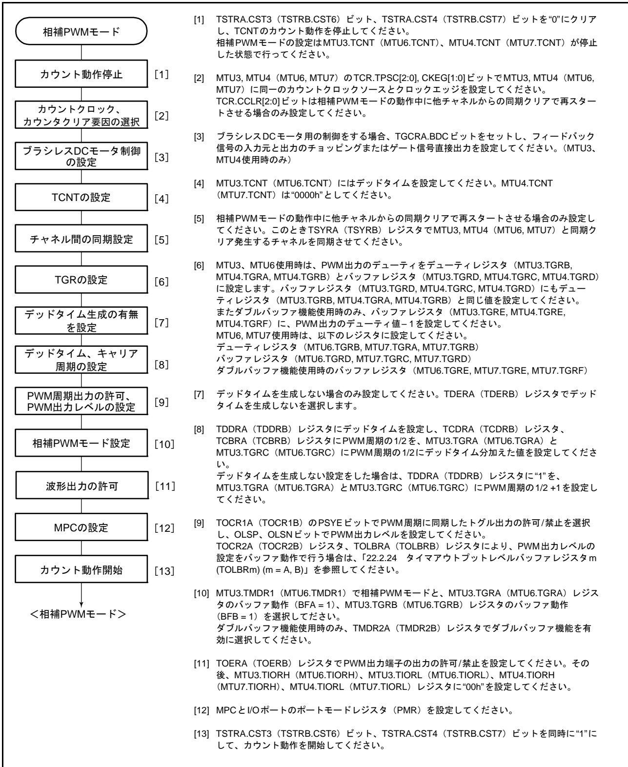
図 22.48 相補 PWM モードの設定手順例
