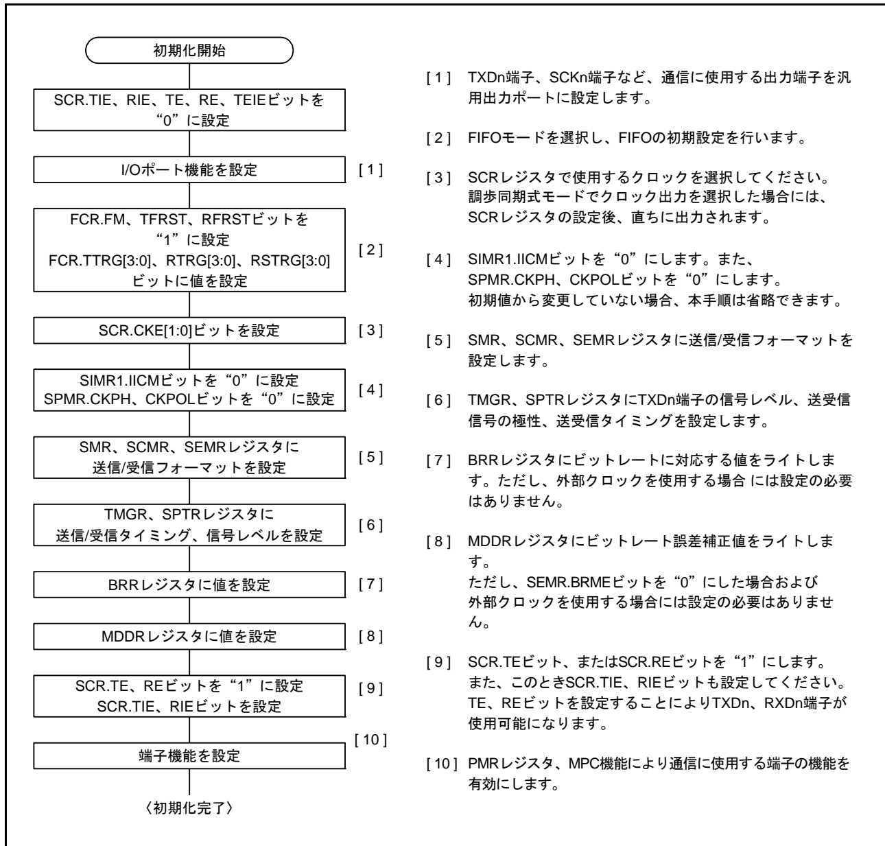
図 30.14 SCI の初期化フローチャートの例 (調歩同期式モード、FIFO 使用) (SCI10, SCI11)
