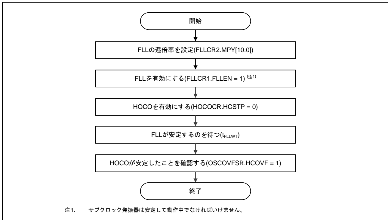
図 9.2 FLL 設定フロー (リセット解除後 / ディープソフトウェアスタンバイモード解除後)
