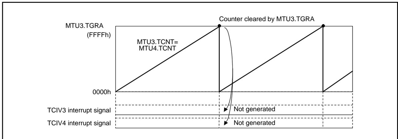
Figure 21.119 Overflow Flags in Reset-Synchronized PWM Mode
