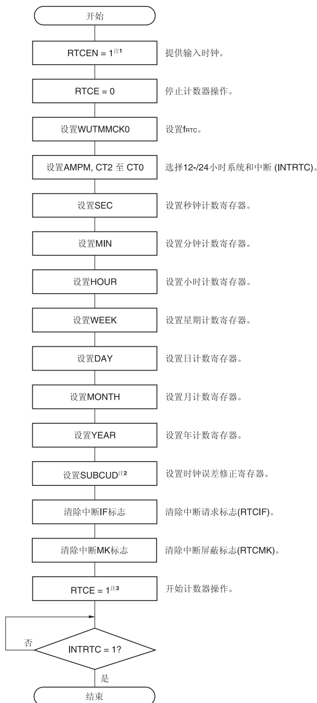
图 9-17. 开始实时时钟的操作步骤
