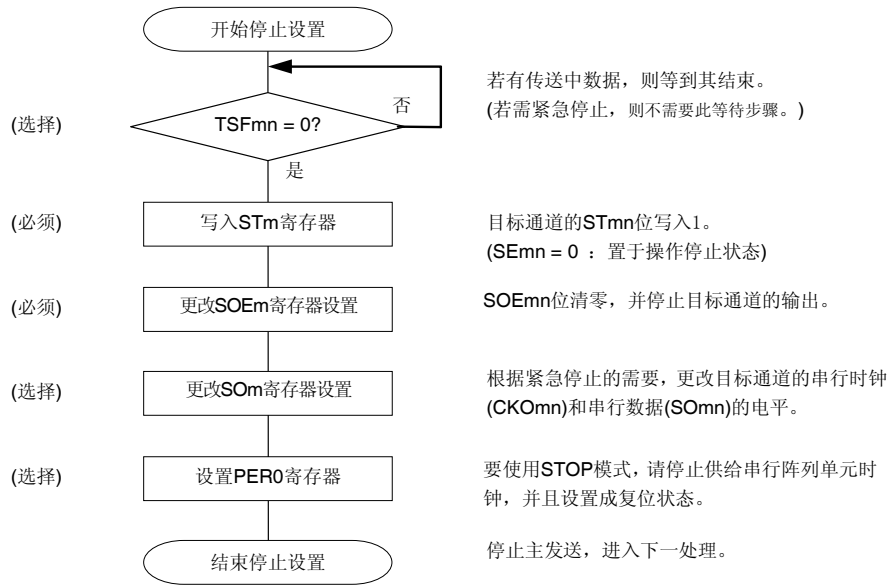
图 15-43. 停止主发送/接收的步骤
