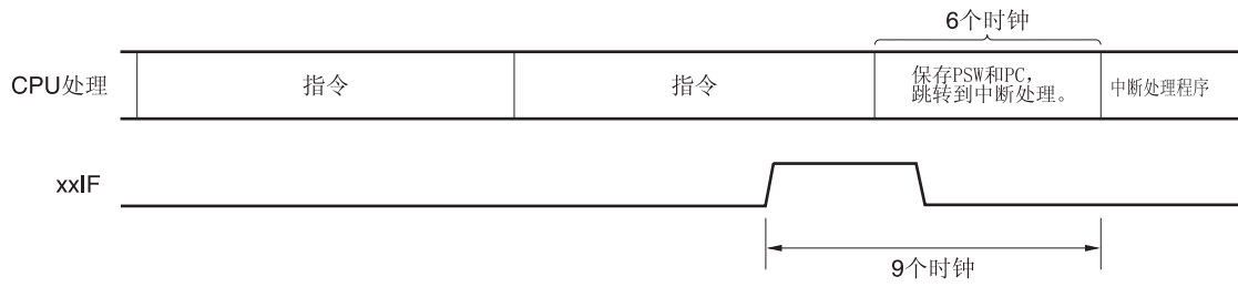
图 20-11. 中断请求受理时序 (最短时间)
