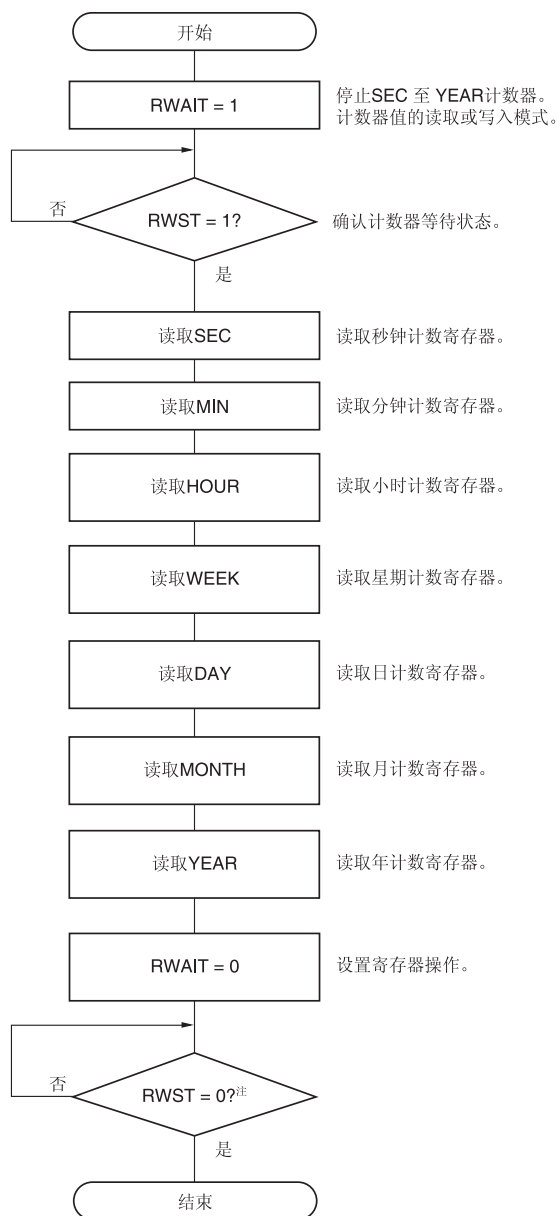
图 9-19. 读取实时时钟的步骤
