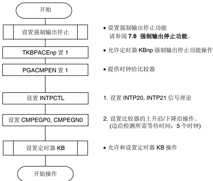
图 14-16. 比较器(CMP)的操作设置流程 2 (使用 INTPm、INTPmHZO 输出时(仅使用边沿电路))
