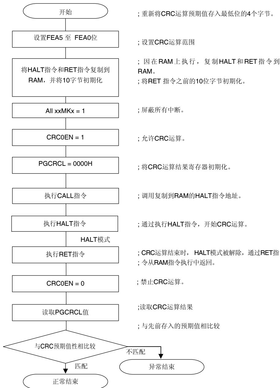
图 25-3. 闪存 CRC 运算功能(高速 CRC)的流程图
