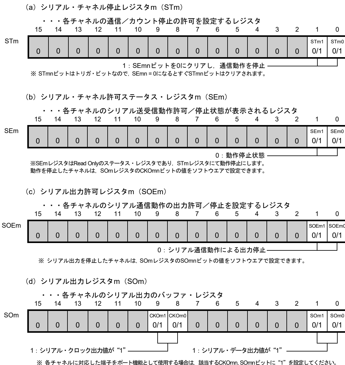
図12-20 チャンネルごとに動作停止とする場合の各レジスタの設定
