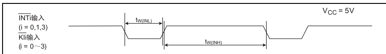
图 32.11 V_{CC}=5V 时的外部中断 \overline{INTi} 和键输入中断 \overline{Kli} 的输入时序
