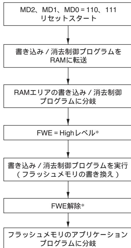
【注】FWE端子に常時Highレベルを印加しないでください。FWE端子にHighレベルを印加するのはフラッシュメモリに書き込み、消去を行うときのみとしてください。また、FWE端子にHighレベル入力中においても、過剰書き込み、過剰消去にならないように、ウォッチドッグタイマを起動し、プログラムの暴走等に対応できるようにしてください。
