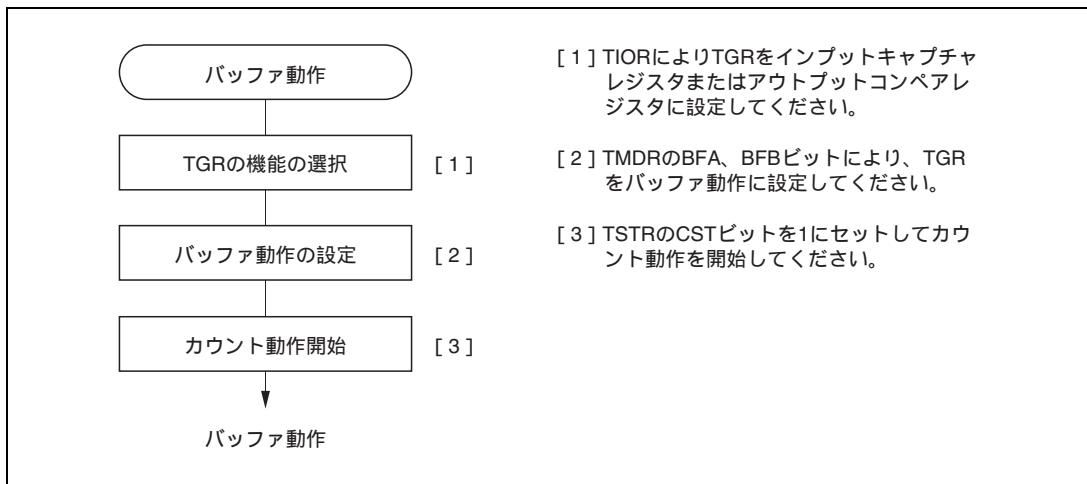
図 11.18 バッファ動作の設定手順例
