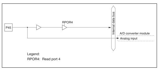
Figure C.10 Port 4 Block Diagram (Pin P45)
