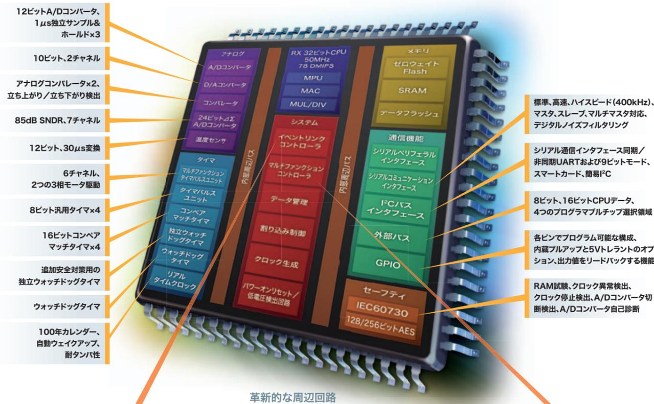
イベントリンクコントローラ (ELC) は、1つの周辺回路またはモジュールから別のモジュールへ割り込みイベント信号を直接入力することにより負荷を軽減する革新的な手段です。これにより、消費電力、割り込み待ち時間、およびプログラムサイズを最小化します。
