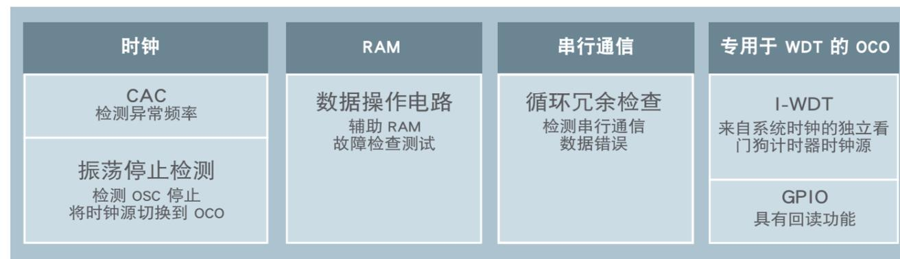
CAC: 时钟频率精度检测电路 OCO: 片上振荡器
