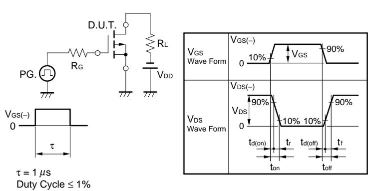
**TEST CIRCUIT 3 GATE CHARGE**
