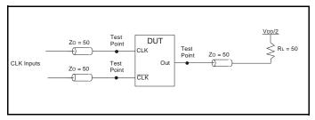
**Production-Test Load Circuit**
