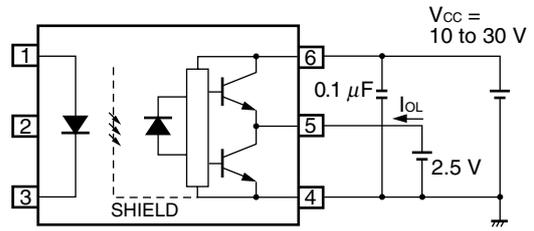
Fig. 3 V<sub>OH</sub> Test Circuit
