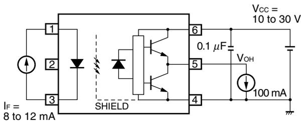
Fig. 4 V<sub>OL</sub> Test Circuit
