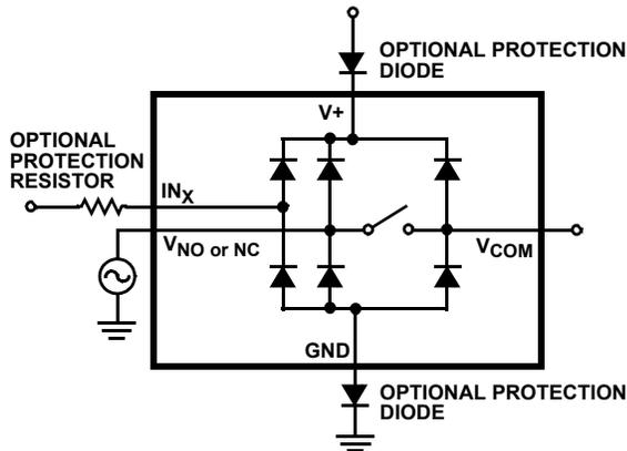
FIGURE 8. OVERVOLTAGE PROTECTION
