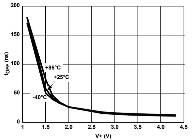
FIGURE 16. TURN - OFF TIME vs SUPPLY VOLTAGE
