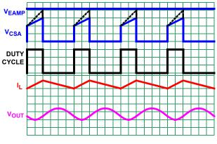
FIGURE 35. PWM OPERATION WAVEFORMS
