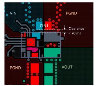
FIGURE 39. LAYOUT EXAMPLE - TOP LAYER
