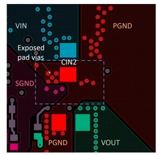
FIGURE 40. LAYOUT EXAMPLE - BOTTOM LAYER
