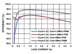
FIGURE 2. EFFICIENCY vs LOAD 5VIN
