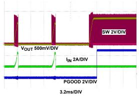
FIGURE 26. OUTPUT SHORT-CIRCUIT RECOVER FROM HICCUP
