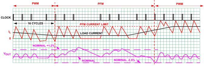
FIGURE 34. PFM MODE OPERATION WAVEFORMS
