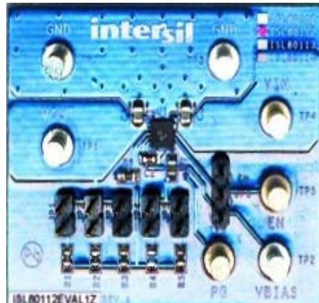
図 39. ISL80113EVAL1Z (左: PCB 上面、右: 写真)
