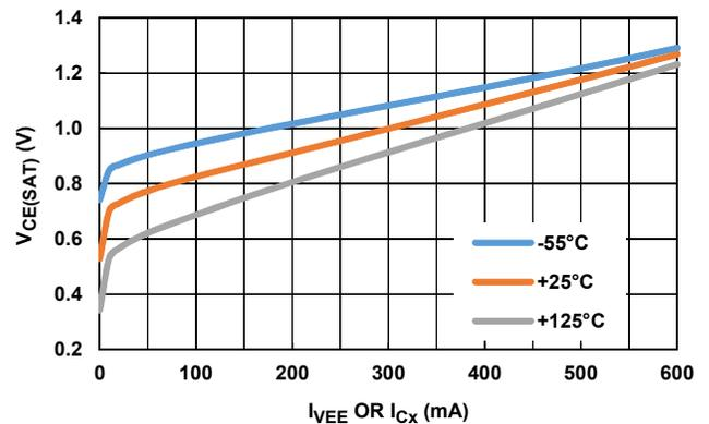
FIGURE 2. V<sub>CE(SAT)</sub> vs I<sub>CX</sub> vs TEMPERATURE
