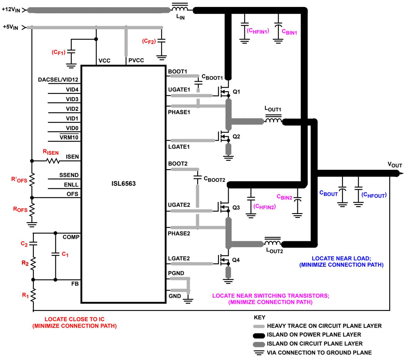
FIGURE 9. PRINTED CIRCUIT BOARD POWER PLANES AND ISLANDS
