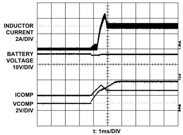
FIGURE 10. BATTERY INSERTION
