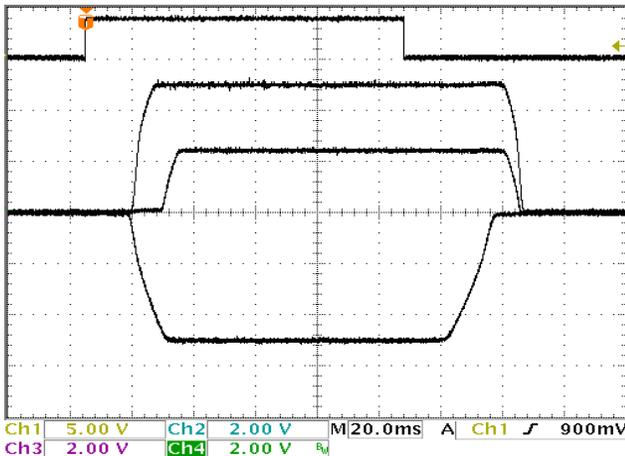
FIGURE 24. ±VOLTAGE SEQUENCING
