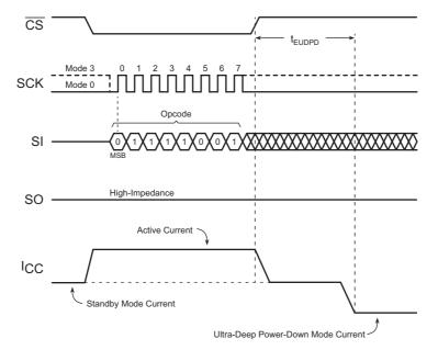
Figure 28. Entering Ultra-Deep Power-Down State
