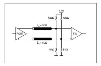
FIGURE 5B. LVPECL OUTPUT TERMINATION
