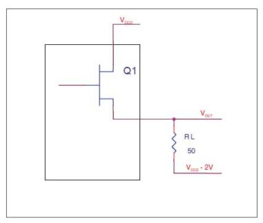
FIGURE 7. LVPECL DRIVER CIRCUIT AND TERMINATION
