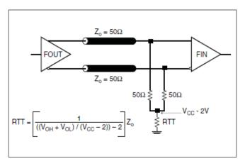
FIGURE 5A. LVPECL OUTPUT TERMINATION
