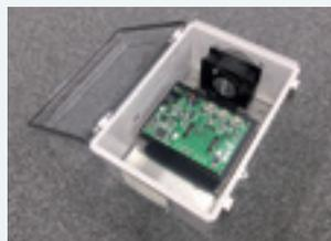
実際の製品で使われる回路と同様のインバータでテストが可能
