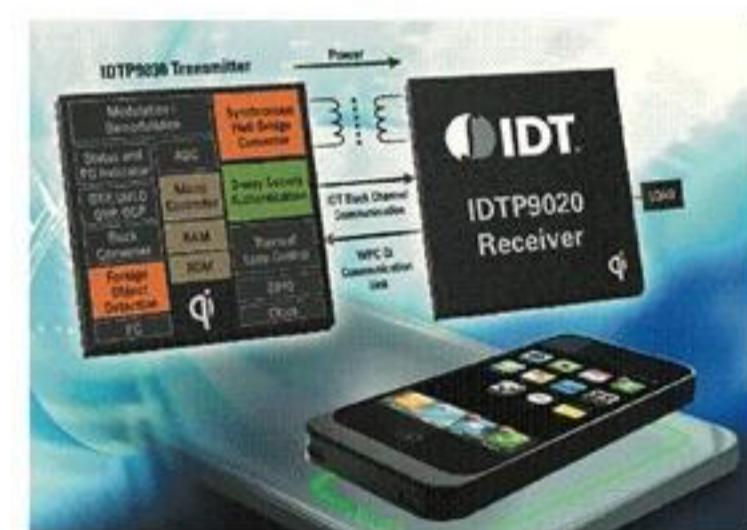
Et trådløst power-transmissionssystem med brug af IDT's IDTP9030- og IDTP9020 komponenter.
