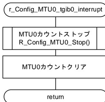
図 3.3 ワンショットパルス出力機能のタイマ割り込み処理
