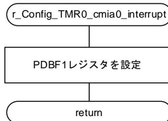
図 3.4 リアルタイム出力機能のタイマ割り込み処理
