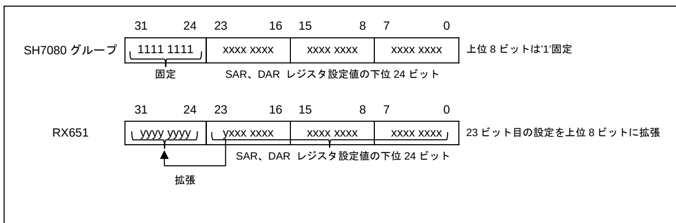
図2.10 ショートアドレスモードにおける転送元および転送先アドレス
