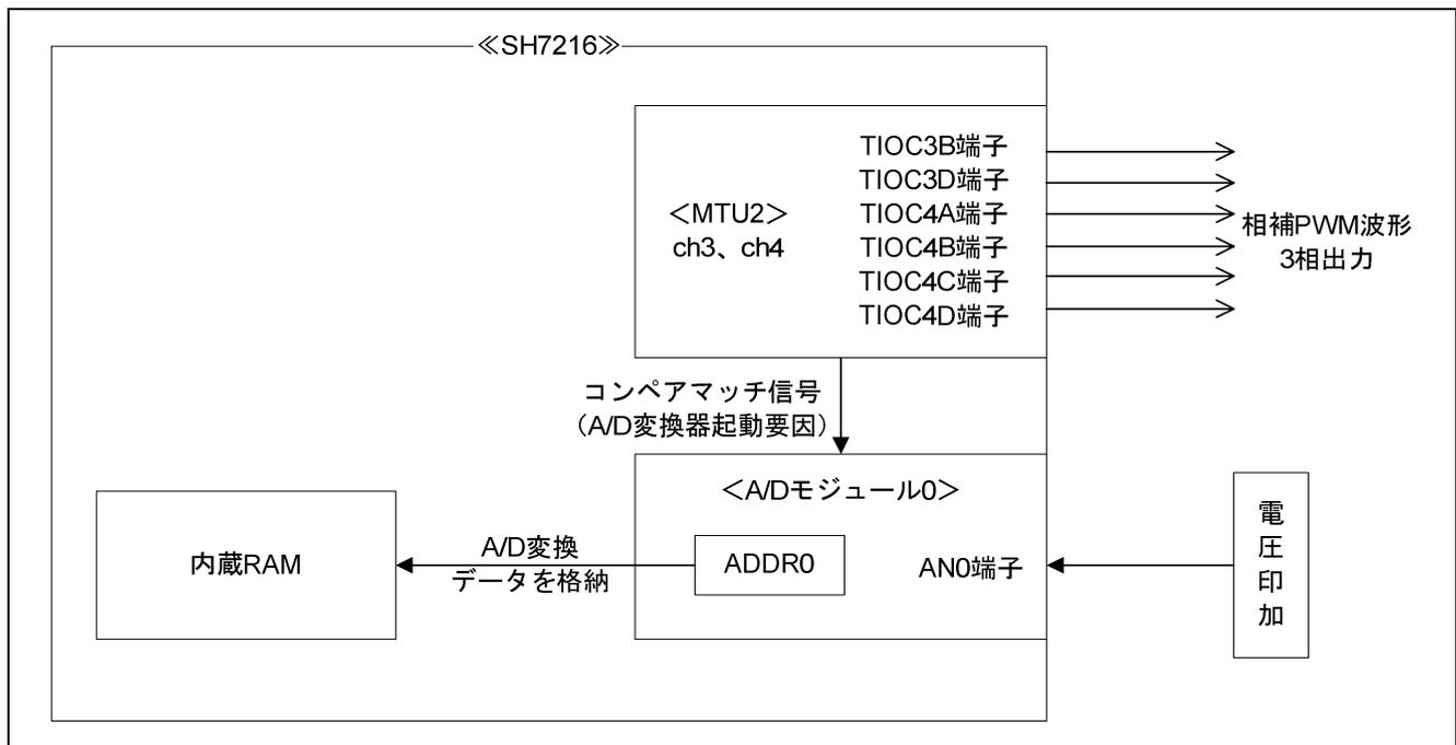
図 1 MTU2 による A/D 変換ブロック図
