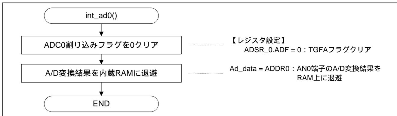
図 13 A/D 変換終了割り込みフロー
