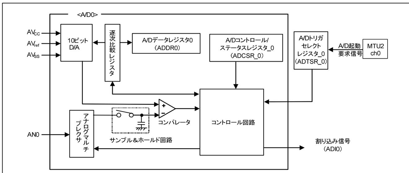
図 5 A/D モジュール 0 のブロック図
