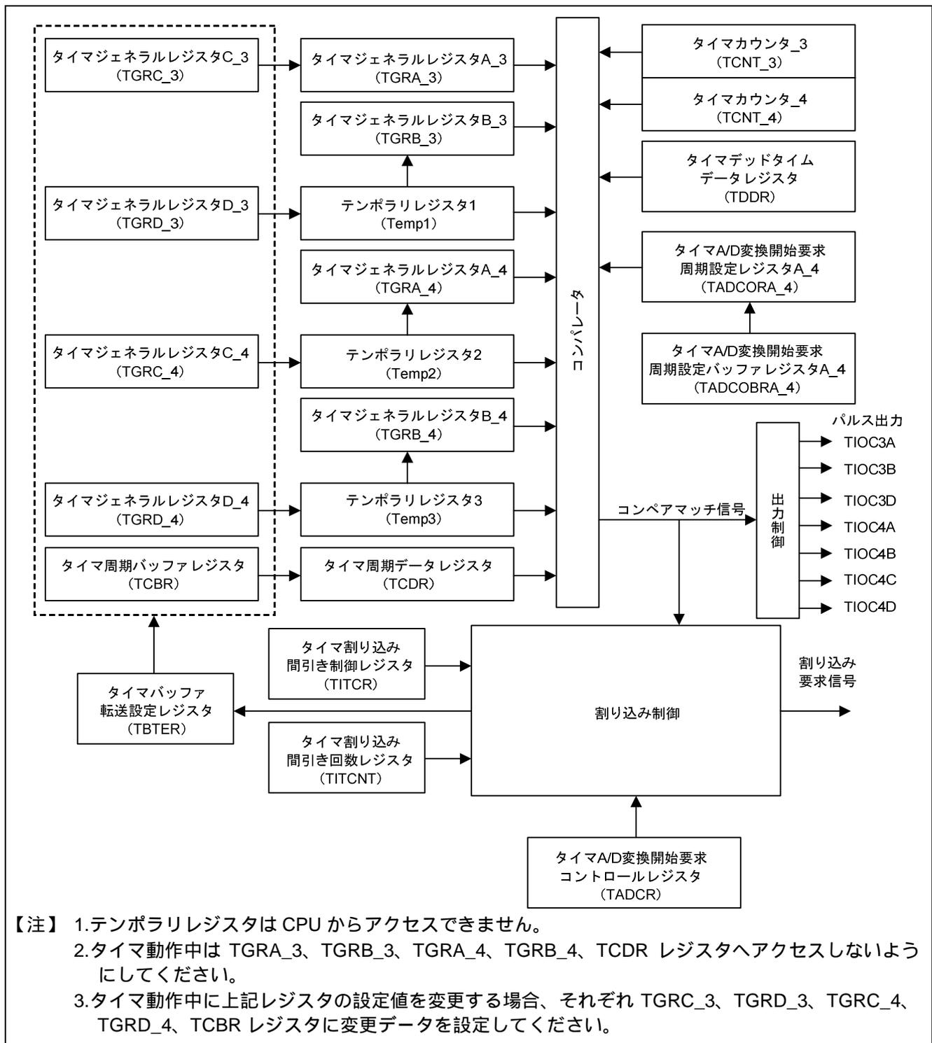
図 4 A/D 変換開始要求遅延機能使用時の MTU2 (ch3、ch4) のブロック図
