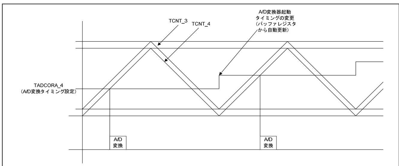
図 2 A/D 変換器の起動
