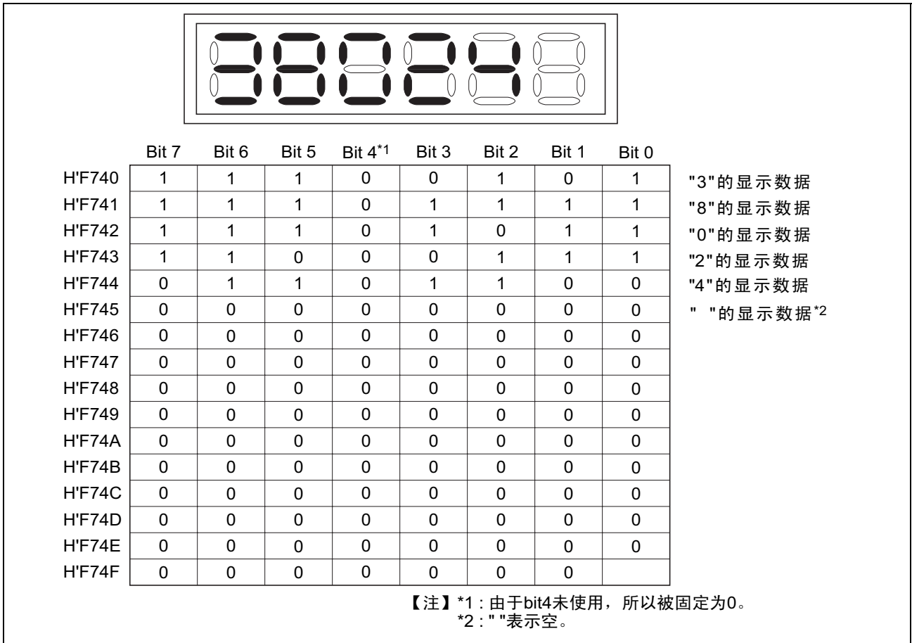
图 5 LCD 显示和 LCD RAM 设定值的关系
