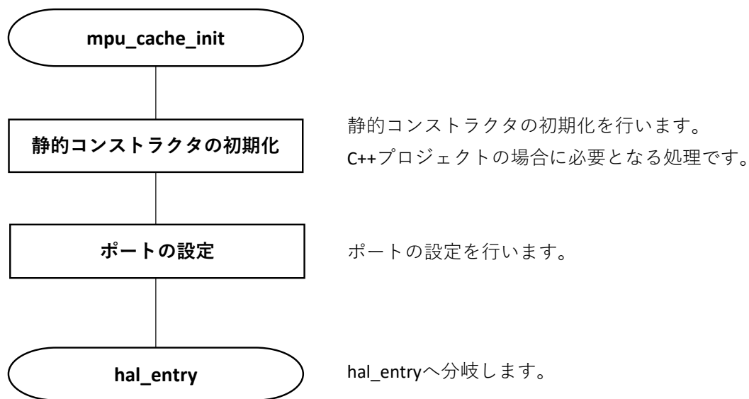
図 3.6 mpu_cache_init 処理(ローダプログラム)
