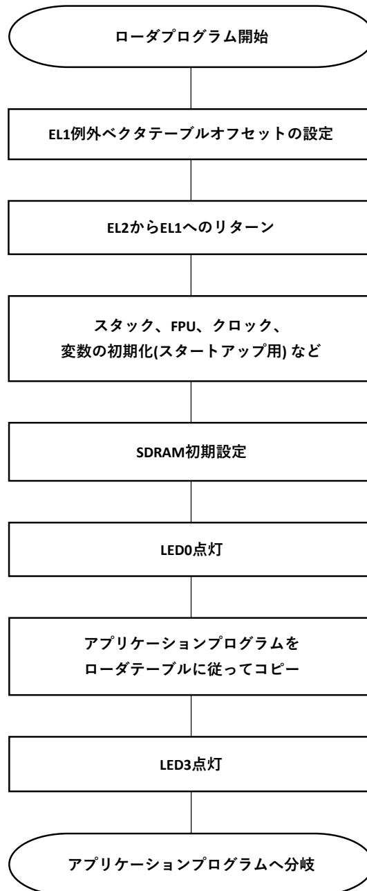
図 3.2 ローダプログラムの動作概要
