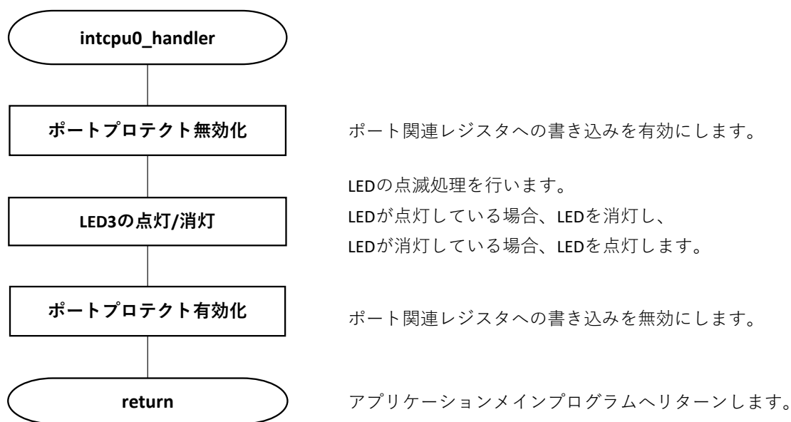
図 3.12 割り込み処理(アプリケーションプログラム)
