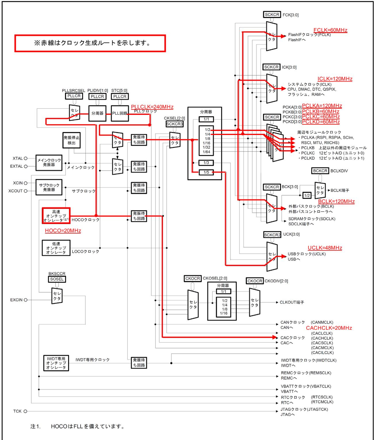
図 5-1 : RX671 クロック生成ブロック図
