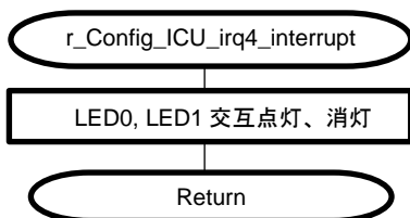
図 2-3 : ユーザスイッチ割り込み動作フロー
