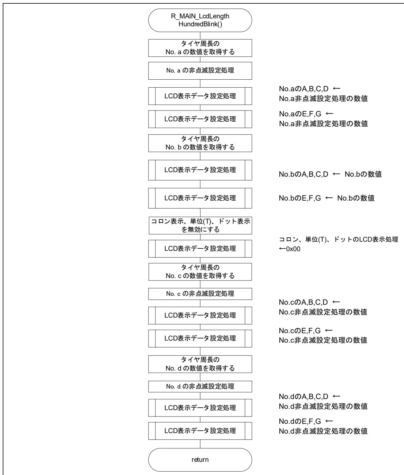
図 4.32 タイヤ周長の百の位の点滅 LCD 表示
