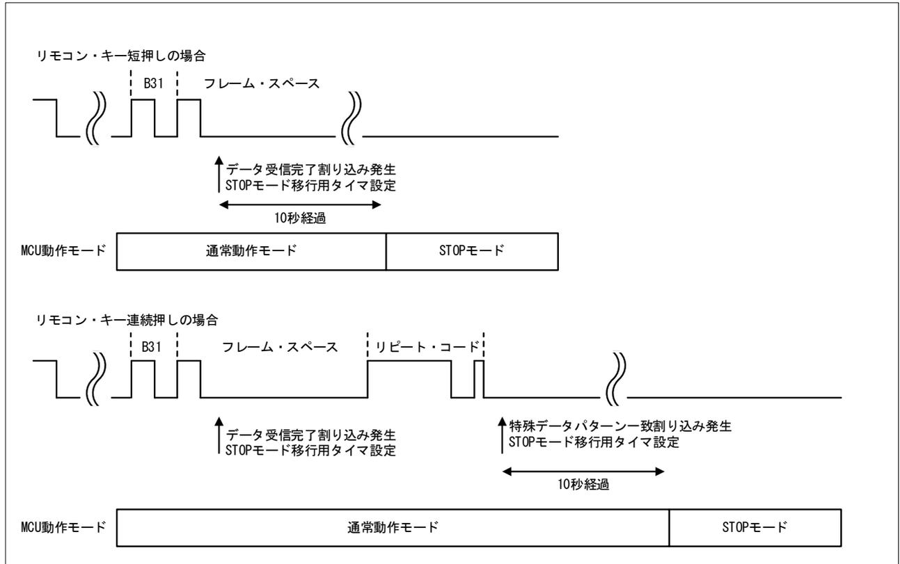
図 1-4 リモコン信号受信の状態遷移図
