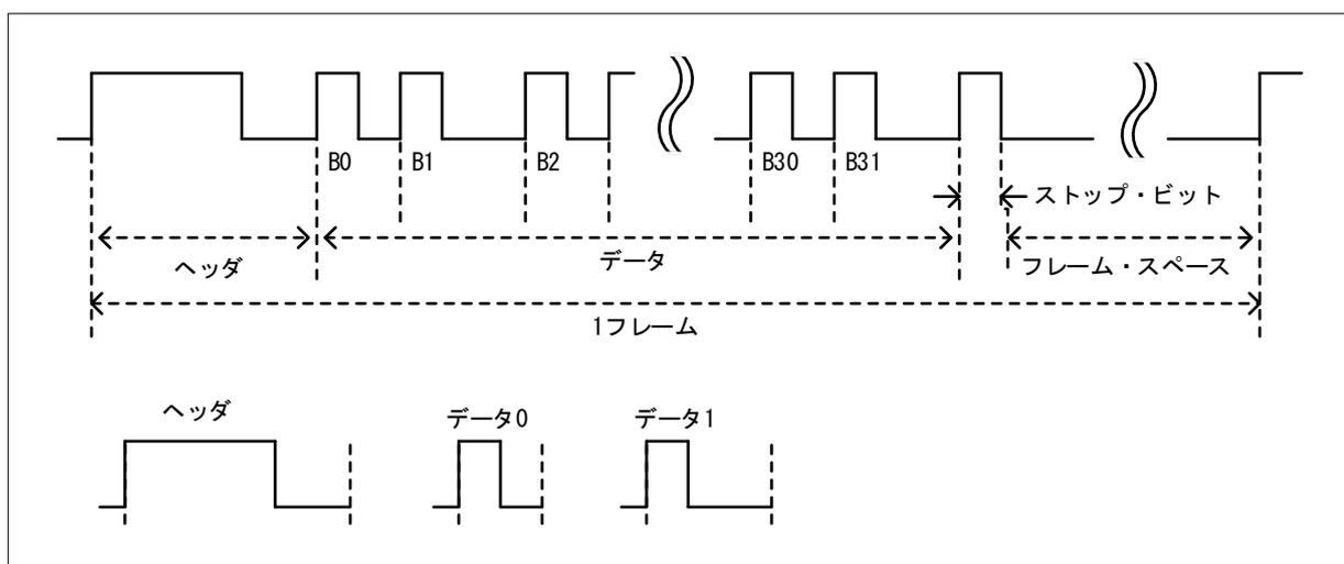
表 1-3にリモコン入力信号とリモコン信号データの対応を示します。受信したリモコン信号データの3バイト目 (図 1-2のB16~B23に該当) が表 1-3のデータと一致した場合、該当チャンネル・ボタンが押されたと判断します。
