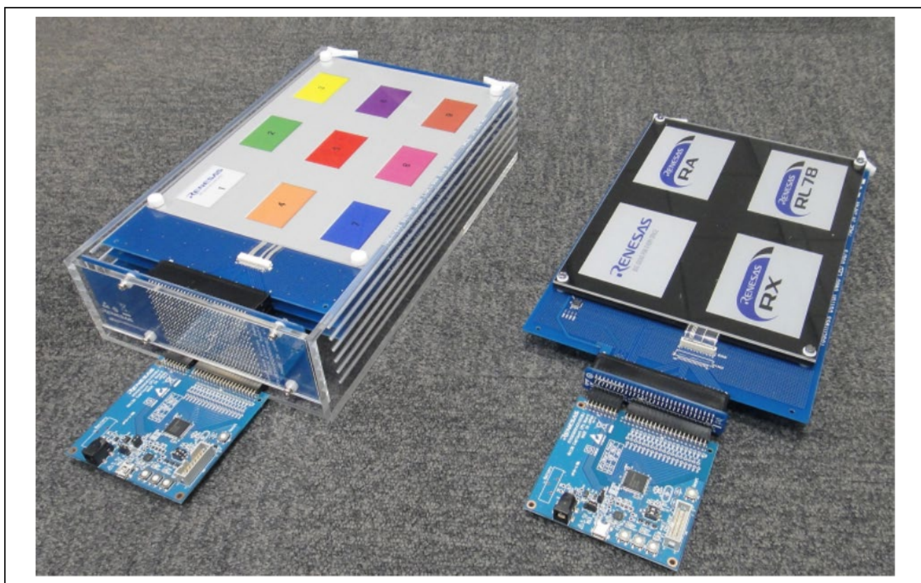
図 1.1 タッチレスボタン電極ボード（左：筐体あり、右：筐体なし）
