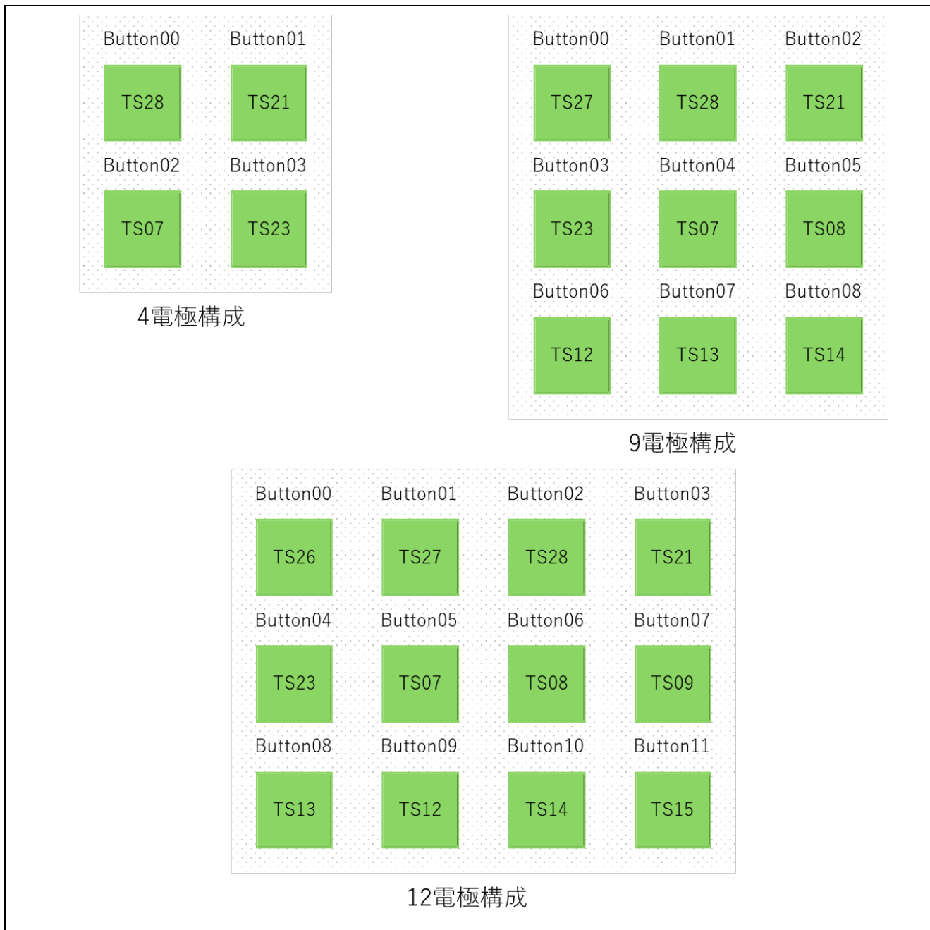
図 5.2 タッチインタフェース構成
