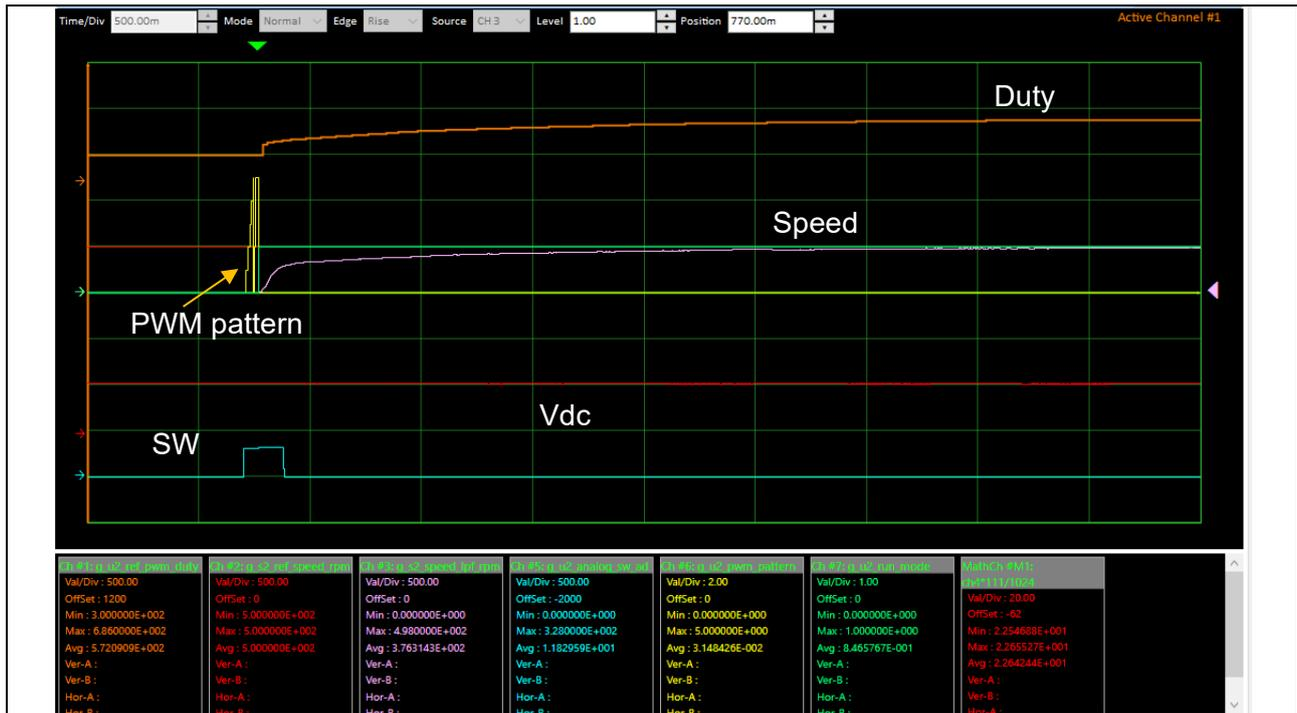
図 4-3 ”Scope Window”での始動波形の観測
