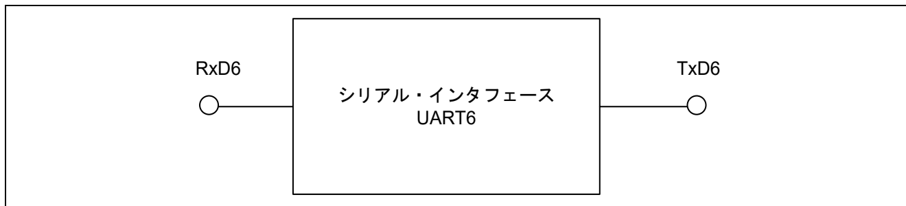
図 1.1 シリアル・インタフェース UART6 のブロック図
