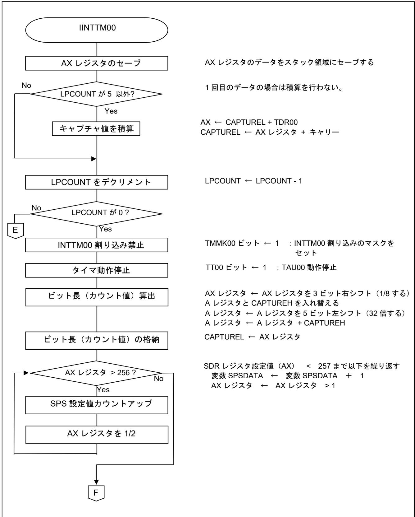
図 5.14 IINTTM00 割り込み処理(1/2)
