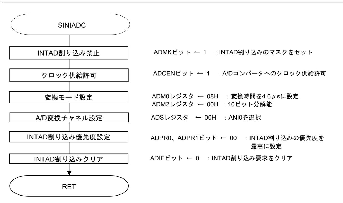
図 5.5 A/D コンバータの設定
