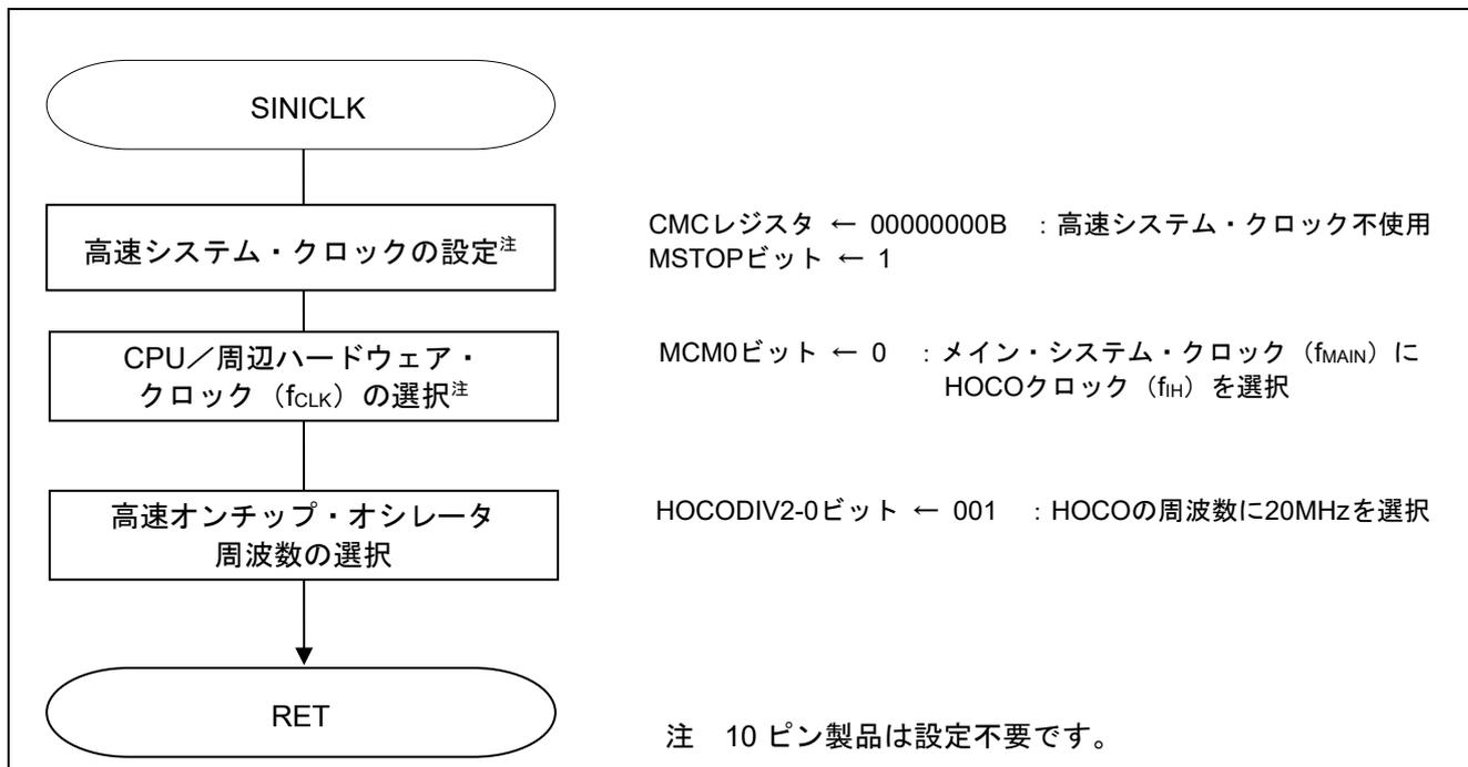
図 5.4 クロック発生回路の設定
