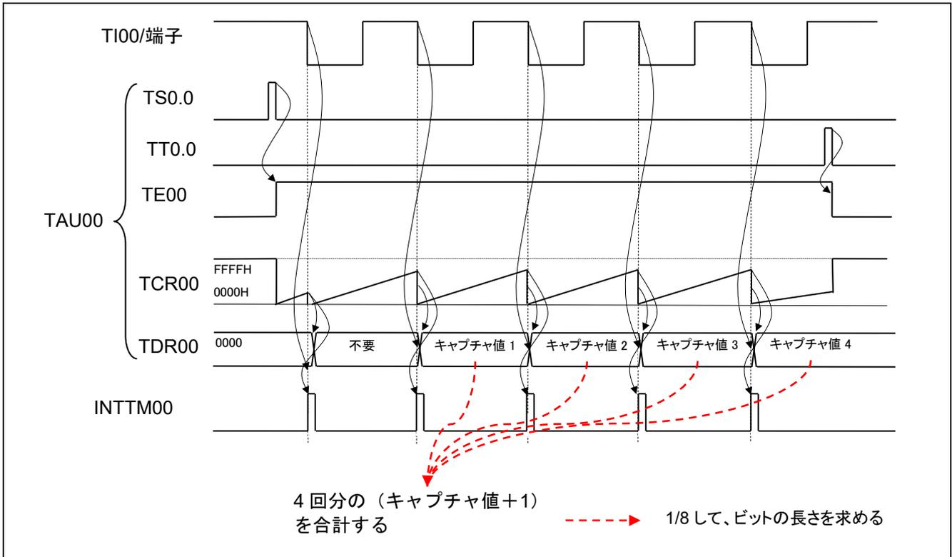
図 1.2 ポーレート測定動作概要のタイミングチャート
