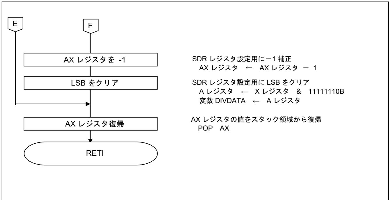
図 5.15 IINTTM00 割り込み処理(2/2)
