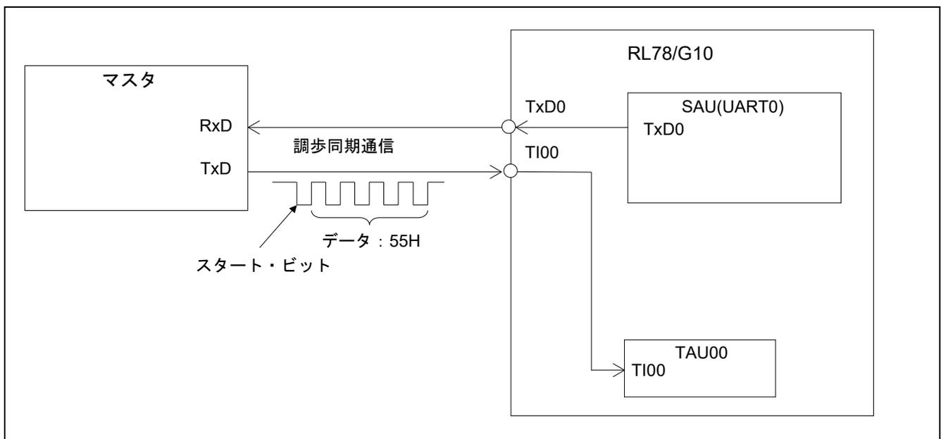
図 1.1 ボーレート測定の構成
