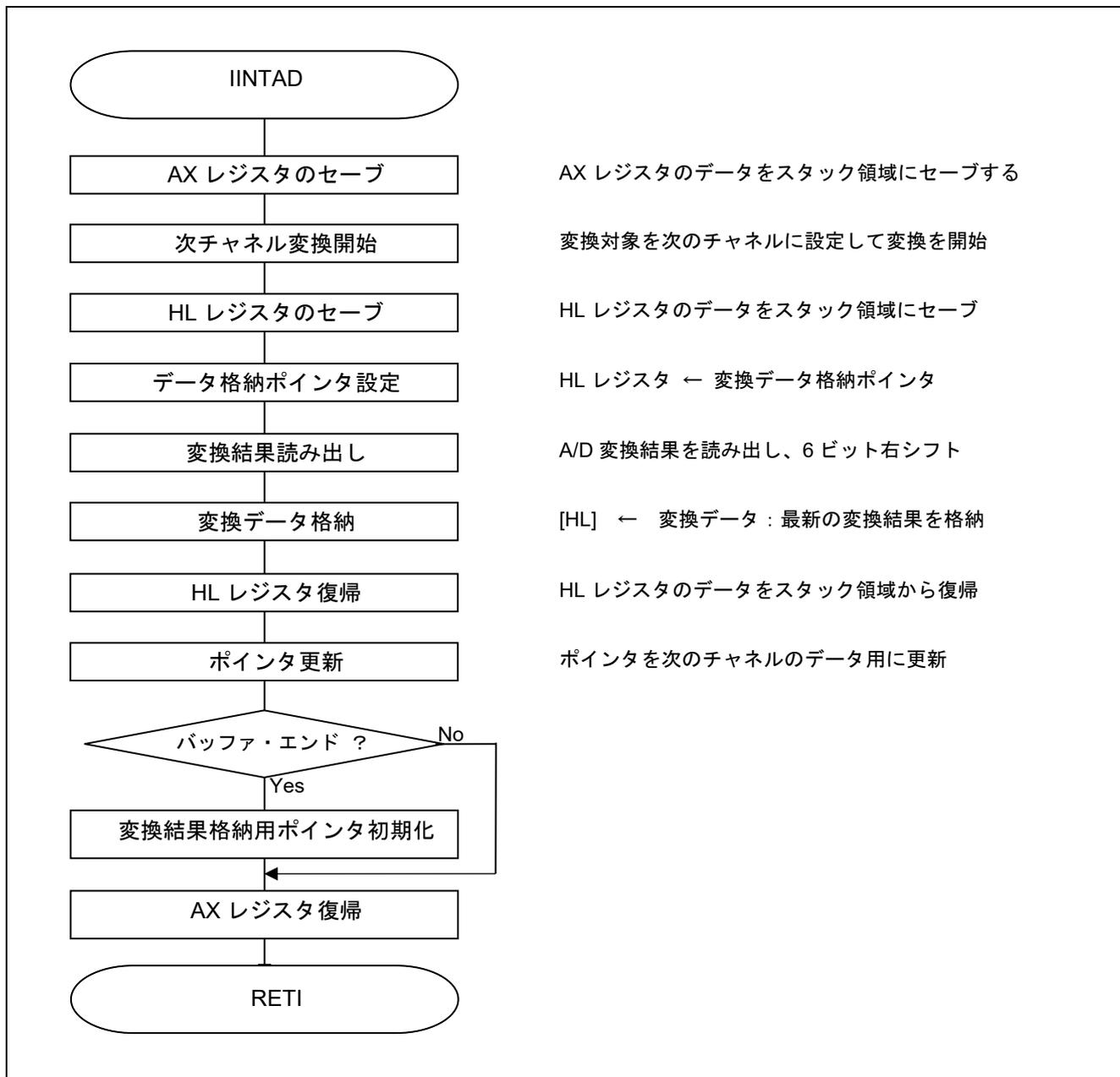
図 5.13 A/D 変換終了割り込み処理
