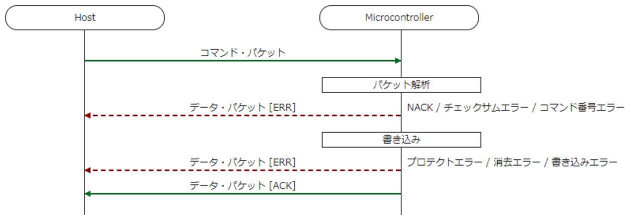
図 6-13 Flash Shield Window Set コマンド
