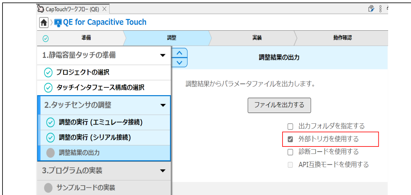
図 5-7 QE for Capacitive Touch での外部トリガ選択設定
