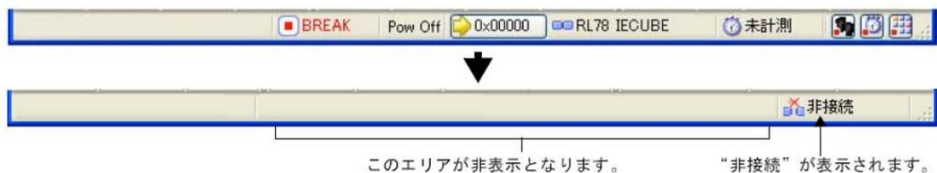
図 4-5 デバッグ・ツールから切断したステータスバー
