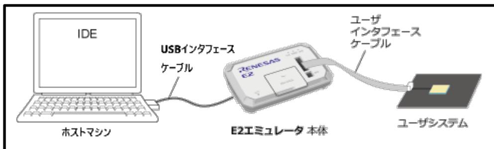
図 2-1 システム構成 (E1/E20/E2 エミュレータ)
