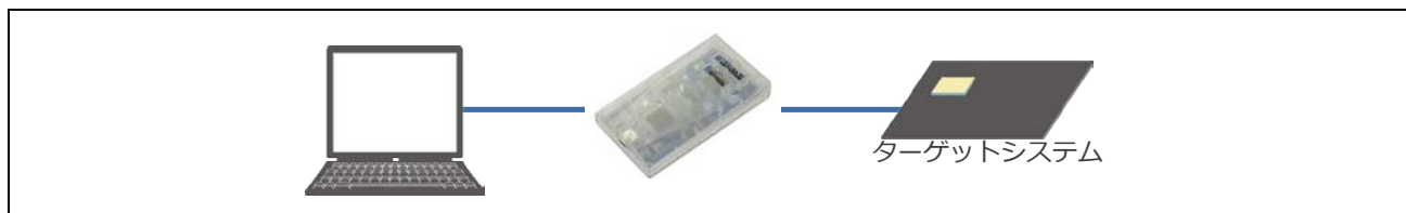
図 2.2 ターゲットシステムの接続
