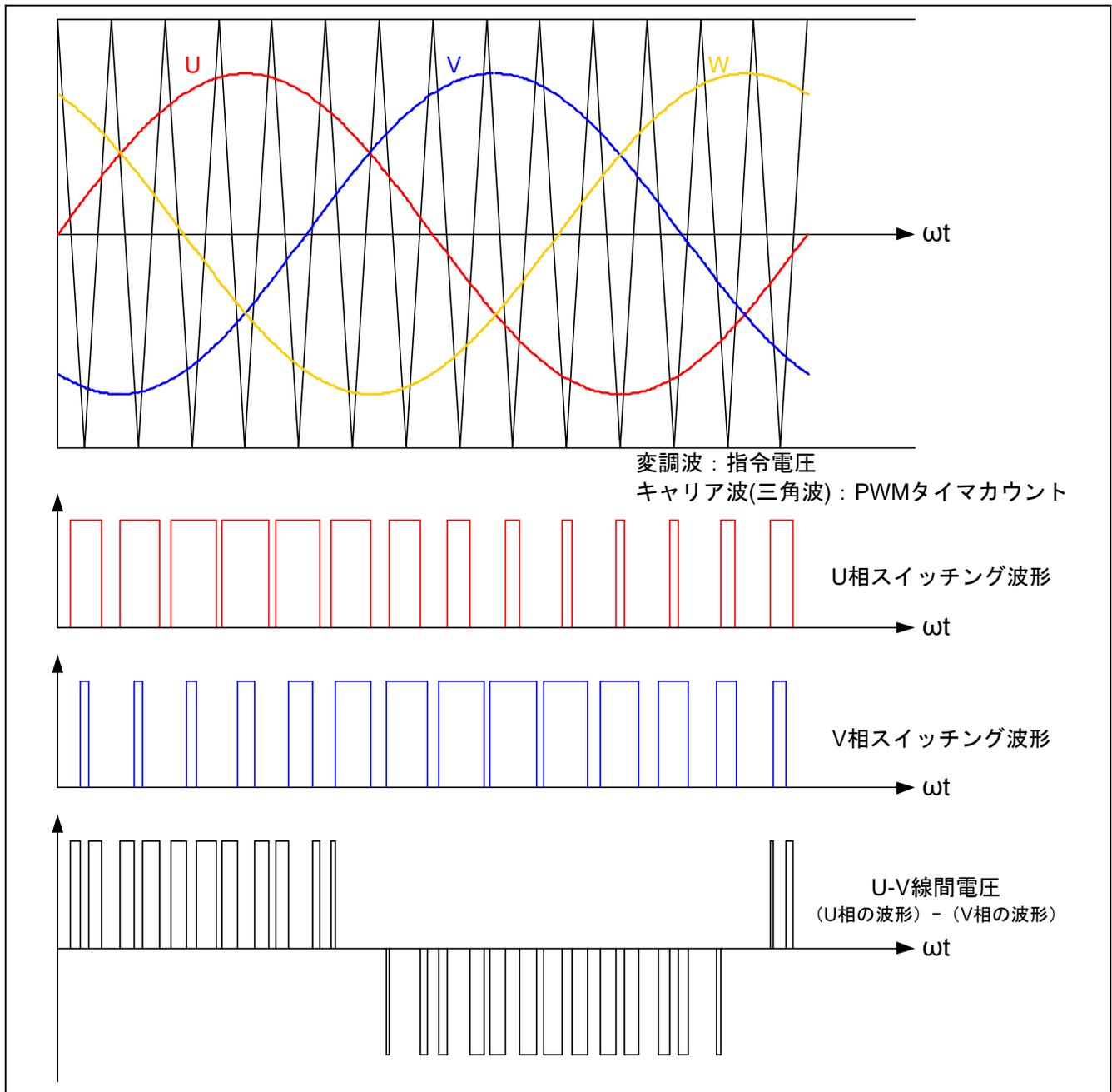
図 3-1 三角波比較法の概念図
