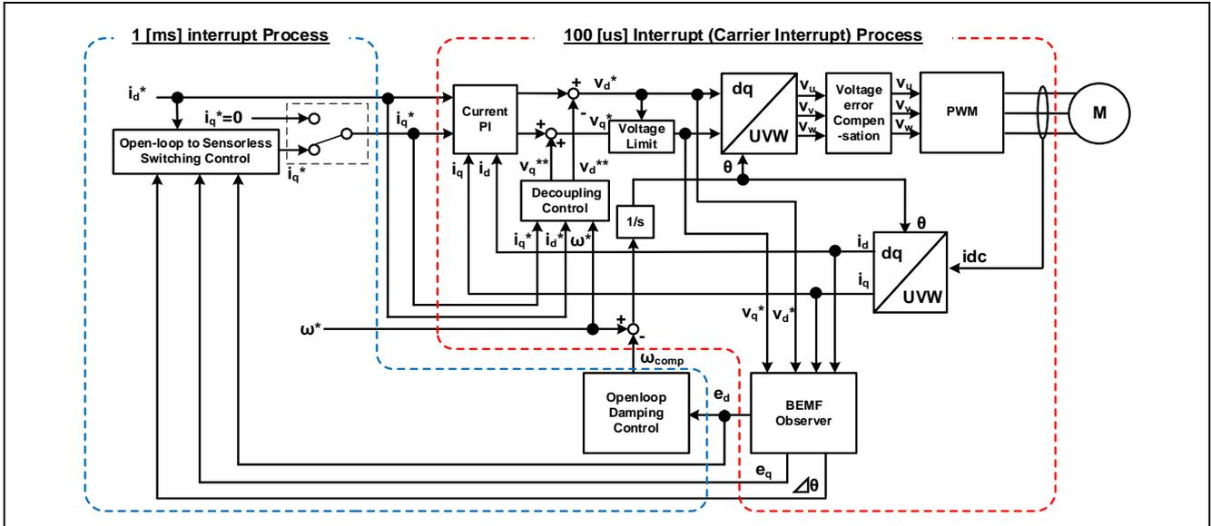
図 3-9 センサレスベクトル制御概略ブロック図(オープンループ制御時)
